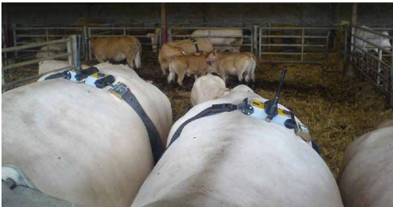
Photo 1 : Ceinture de mesure des contractions utérines. Agrimonitor.
